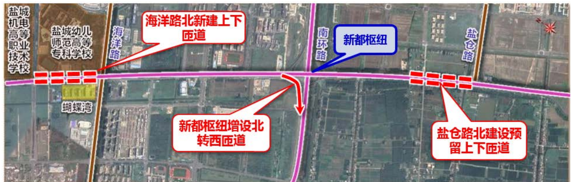
图 2.6.3-1 海洋路北增设上下匝道改造图
